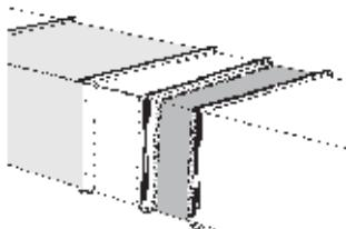
Для монтажа вентилятора рекомендуется использовать гибкие соединительные вставки, которые существенно сокращают передачу шума в воздуховод.
