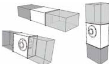
Вентилятор может устанавливаться в любом положении. При подключении воздуховодов обратите внимание на направление воздушного потока, указанное на корпусе изделия.
