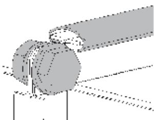
К воздуховодам вентилятор монтируется болтами и С-профилем.
