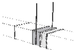
Если используются гибкие соединения, необходимо дополнительно прикрепить вентилятор к полу, стене или потолку.
