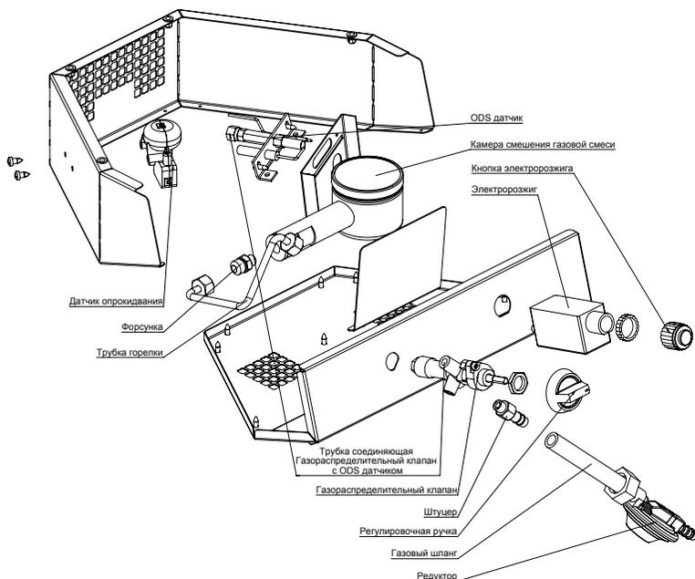
Рис. 3 Устройство блока управления (приборного отсека) модели BOGH-15
