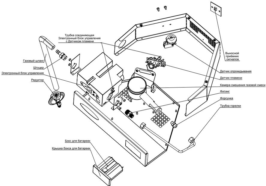
Рис. 5 Устройство блока управления (приборного отсека) модели BOGH-15E
