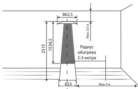
Рис. 1в Размеры прибора и допуски (0,5 min)
