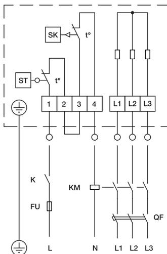
SK — термостат защиты от перегрева с автоматическим возвратом, температура срабатывания 60 °С;
