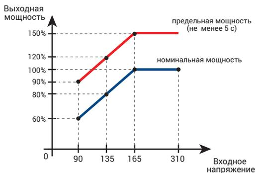
**Рисунок 10.** Зависимость выходной мощности от входного напряжения
