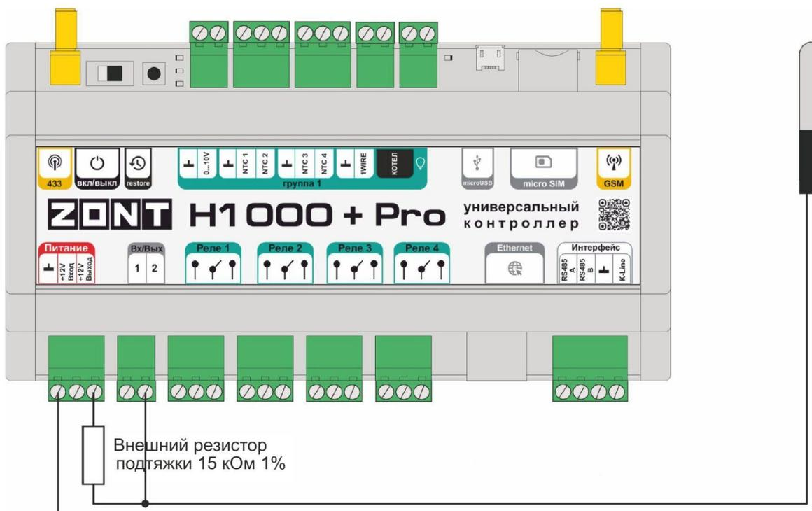
При таком подключении датчика NTC-10 требуется использовать между входом и клеммой питания “+12 В” дополнительный внешний резистор 15 кОм 1%.
