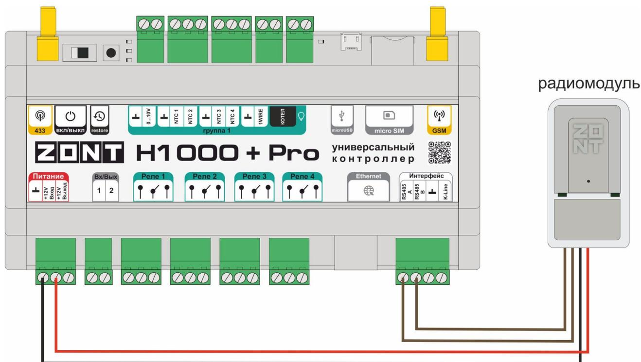
**Примечание:** При необходимости удлинения радиоканала подключаемый радиомодуль разместить в другом помещении (этаже, комнате) относительно Контроллера. При подключении по интерфейсу K-Line максимальное расстояние 15 м, а при подключении по интерфейсу RS-485 - 200 м.
