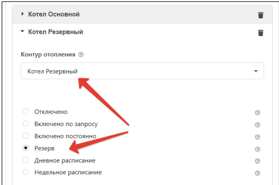
**ВНИМАНИЕ!!!** Если в системе отопления используются более одного котла, то в настройке контура потребителя при выборе источника тепла, которому контур отправляет “запрос на тепло” необходимо выбирать - *все теплогенераторы*.
