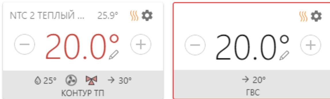
Если целевая температура контура отопления выходит за границы заданного температурного диапазона, то в плашке контура она будет отображаться красным цветом.
