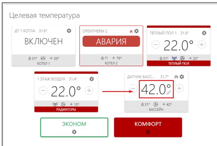
Если это команда от комнатного термостата, то для поддержания задаваемой им температуры в контуре применяется управление исполнительным устройством данного контура. В этом случае нужно выбирать управление **“активностью контура”**. Значение уставки для работы котла определяется также, как и в алгоритме управления бассейном.
