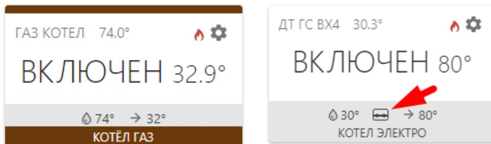
Графический элемент "**Пламя**" – состояние горелки котла. У котла, управляемого релейным способом дополнительно отображается состояние релейного выхода. Отображается только у котлов, управляемых по цифровой шине.
