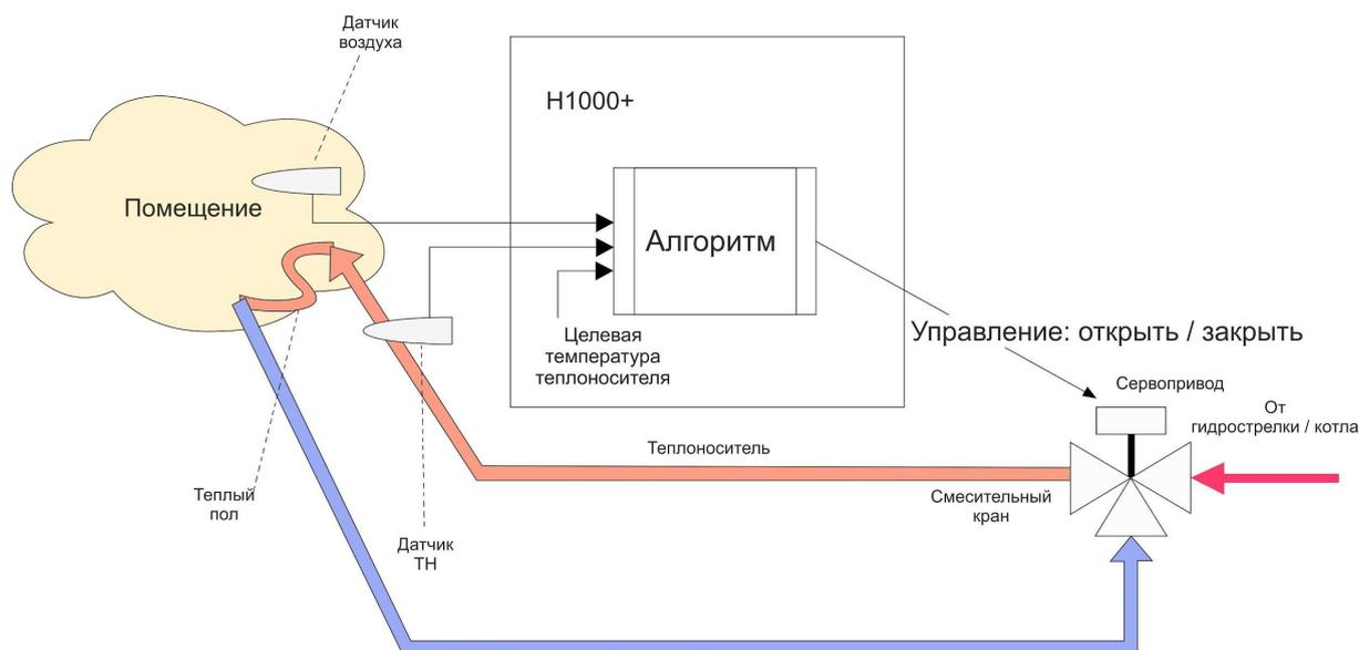
Правильная работа алгоритма требует контроля двух датчиков – воздуха в помещении и теплоносителя в контуре за смесительным краном. ПИД-алгоритм получает расчетную температуру теплоносителя, которая запрашивается контуром у котла и поддерживается работой смесительного крана.
