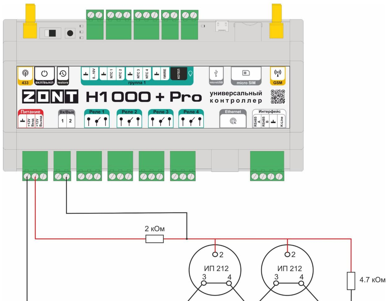
На примере схемы подключения показан шлейф 2-х датчиков дыма ИП-212 с сопротивлением в режиме “Тревога” не более 1 Ком.
