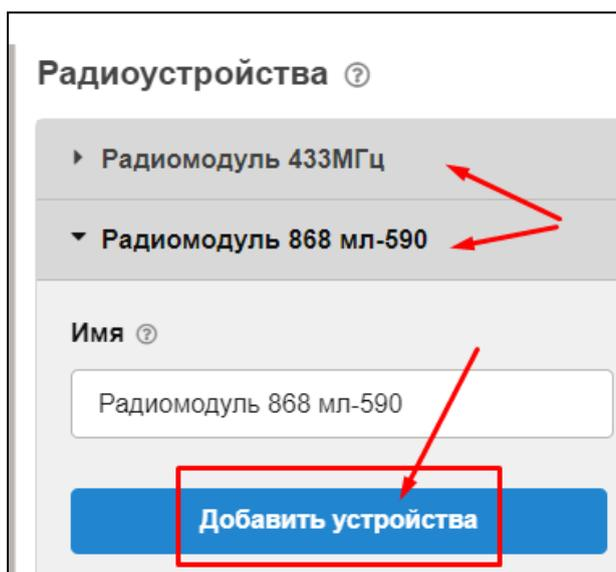
Режим добавления нового радиодатчика включается на 120 сек. В этот промежуток нужно вызвать срабатывание датчика (433) или нажать и удерживать кнопку на плате датчика (868) до загорания на нем индикатора на 1-1,5 сек.
