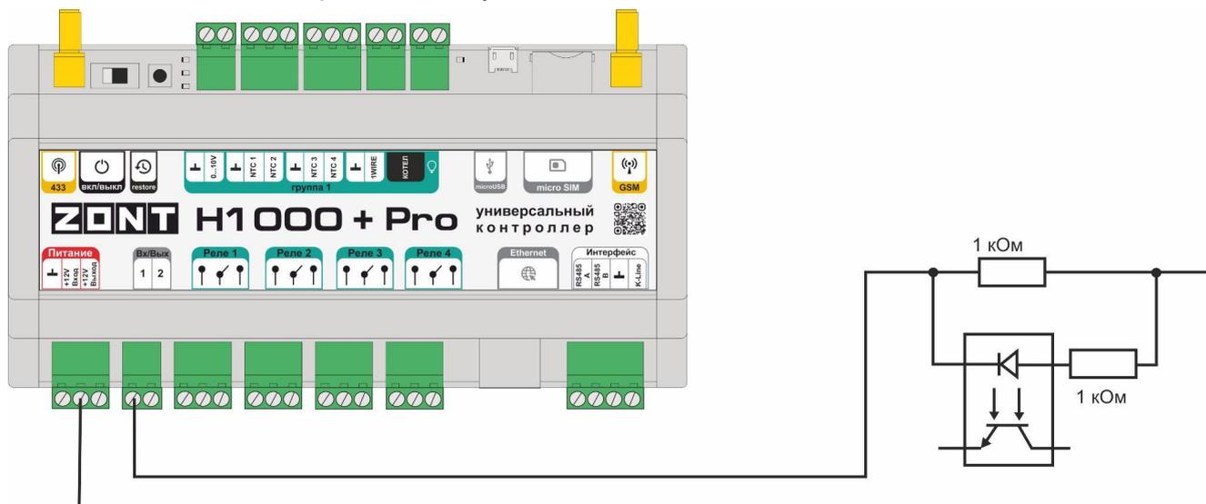
**Низковольтные звуковые и светозвуковые сирены (+12В)** допустимо подключать непосредственно к выходу контроллера. Схема подключения звуковой сирены:
