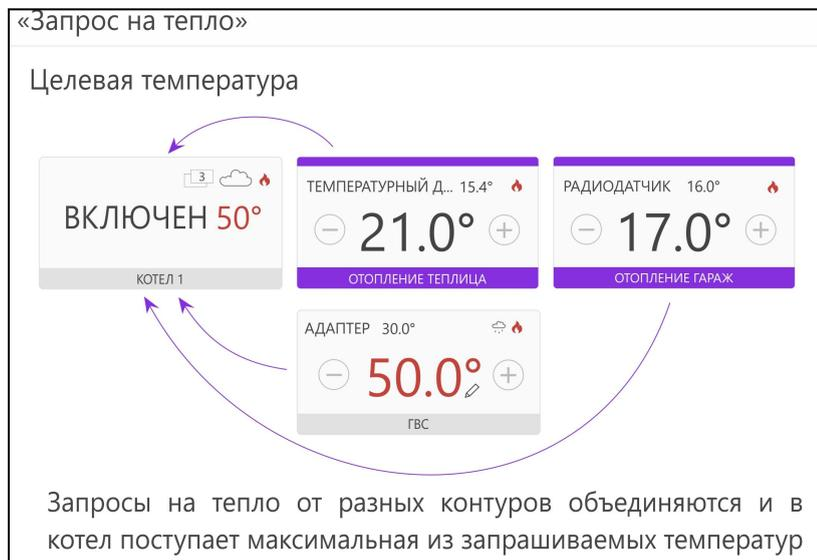
Величина “запроса на тепло” определяется настройкой каждого контура и представляет собой значение расчетной температуры теплоносителя.
