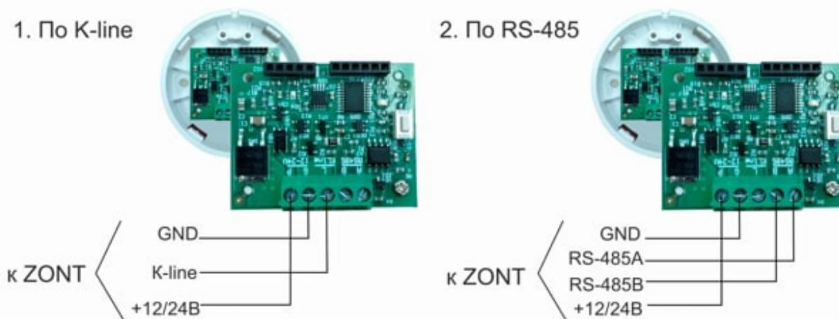
Максимальная длина линии RS-485 не более 200 м. При большем удалении датчика от Контроллера рекомендуется устанавливать дополнительные резисторы 120 Ом между клеммами А и В с обоих концов линии и использовать кабель UTP (витую пару) CAT5.
