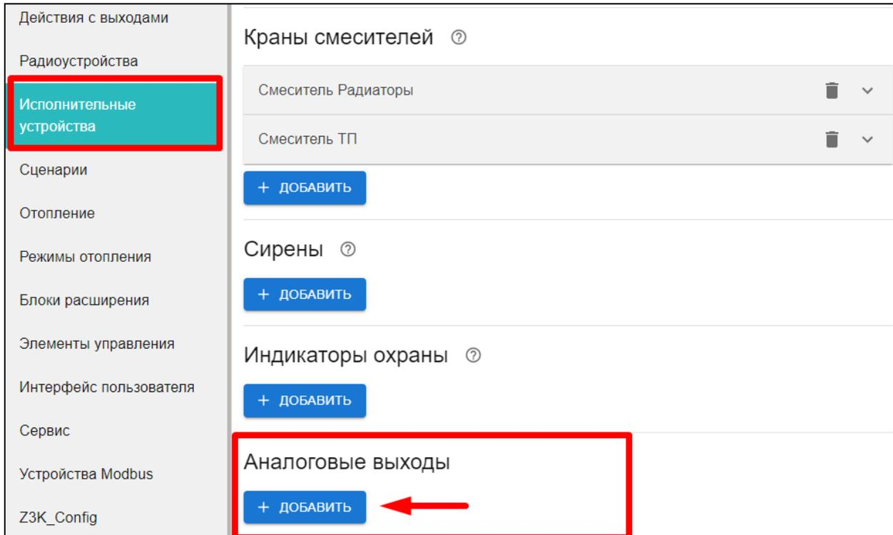
Настройка определяет рабочий диапазон напряжений на выходе и шаг их изменений при применении выхода для управления исполнительным устройством (электроприбором).
