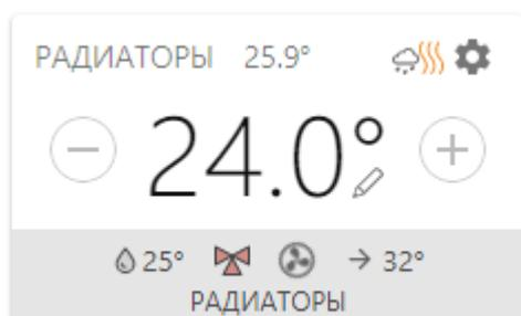
**24.0** – (в центре плашки контура) - целевое значение температуры для действующего в данном контуре режима отопления. Графический элемент "**Карандаш**" – признак ввода целевой температуры в ручном режиме.
