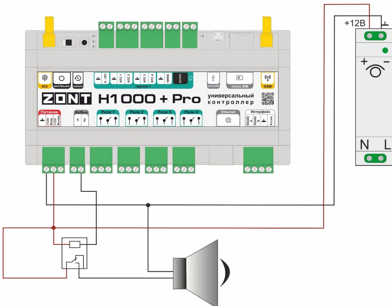
Схема подключения светозвуковой сирены:
