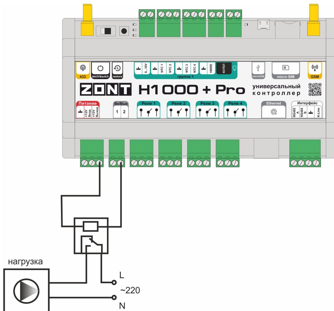
Реле следует выбирать из расчета допустимой нагрузки контактной группы и удобства конструкции реле для монтажа. Как правило, такие реле имеют корпус или колодку для монтажа на DIN-рейку.
