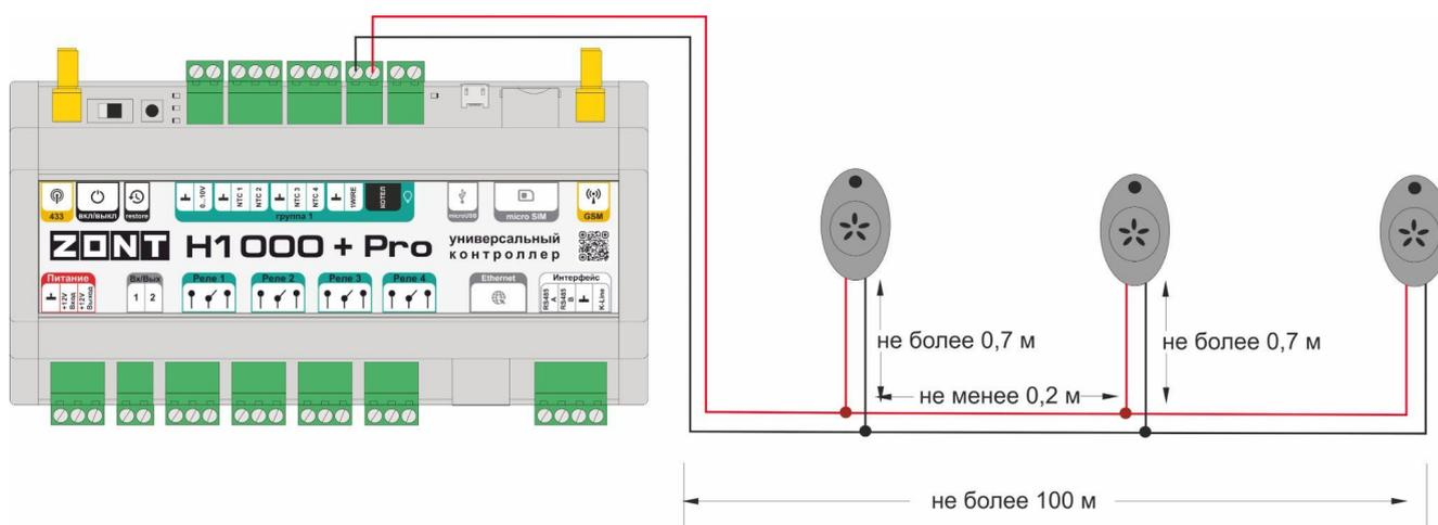
Цифровые проводные датчики температуры чувствительны к импульсным сетевым помехам. Для снижения действия возможных помех и обеспечения стабильной работы датчиков
