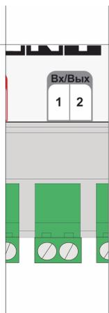
Прежде чем произвести подключение исполнительных устройств к выходам Контроллера, убедитесь, что максимальный ток потребления этих устройств не превышает тока, заявленного в технических характеристиках Контроллера.
