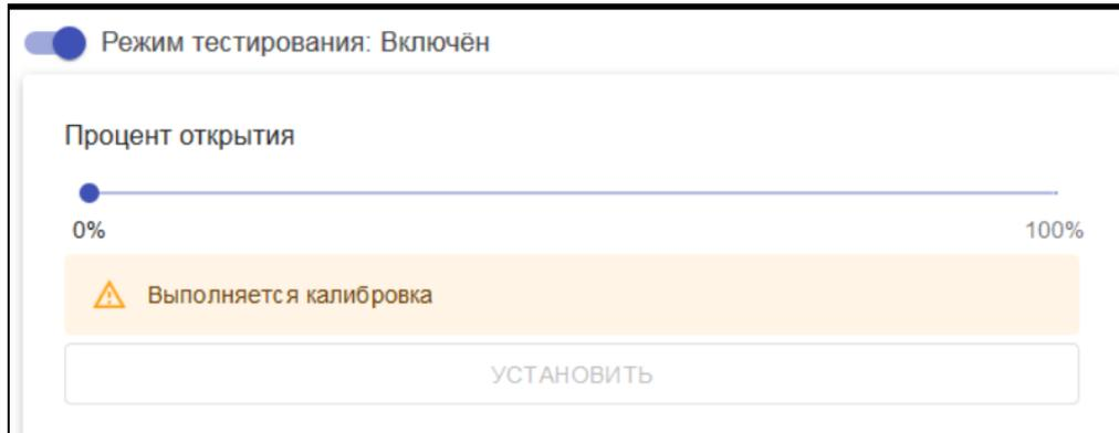
**ВНИМАНИЕ!!!** Используйте данный режим только при пусконаладочных работах. При эксплуатации включение режима для какого-либо исполнительного устройства блокирует управление контуром отопления.
