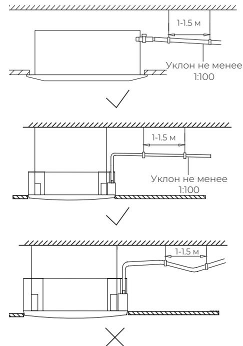
**При прокладке дренажного трубопровода, не допускайте образования**
